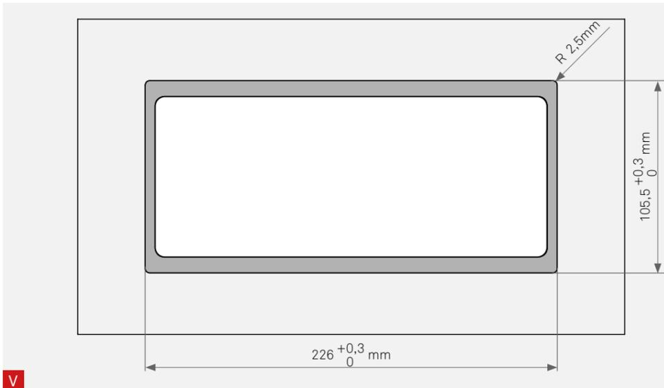
Frästiefe bei flächenbündigem Einbau | Milling depth for flush installation | Profondeur de fraisage pour montage affleurant
