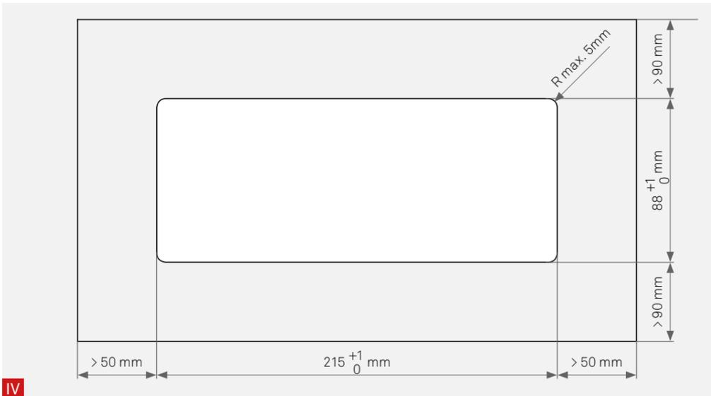
Fräsmaß Flächenbündig | Milling dimension: Flush Mounting | Dimension de fraisage Montage Affleurant
